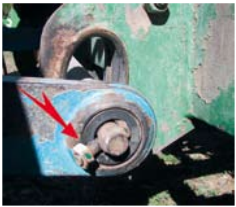
Figure 1 : Utilisation d'un écrou (à gauche) et d'une soupape (à droite) à la place de la goupille d'arrêt sur l'axe d'attelage.
