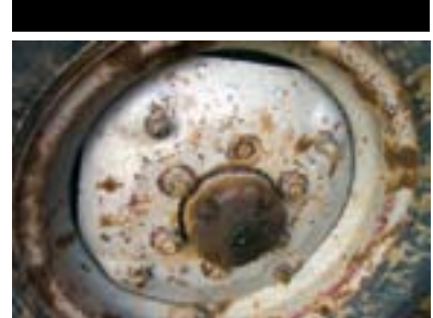
Figure 2 : Lèvre de jante de la roue avant d'un tracteur usée par aversant (Risque de déchirure puis d'éclatement du pneu).
