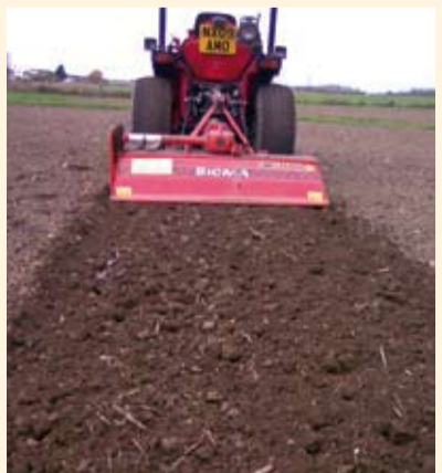
1. la préparation recommandée, réalisée par un seul passage au Rotavator qui remplace 2 à 4 passages au cover-crop
