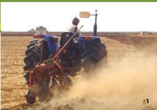
1. Charrue à 3 disques, outil primaire le plus utilisé au Maroc pour le travail profond
