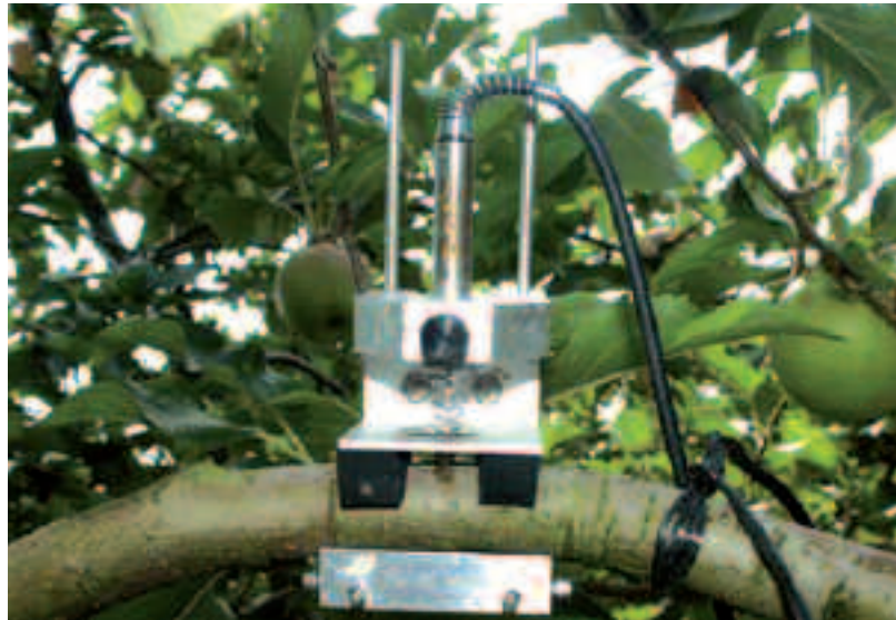
Le Pépista est un appareil qui mesure la croissance du diamètre des branches et l'état hydrique de la plante
